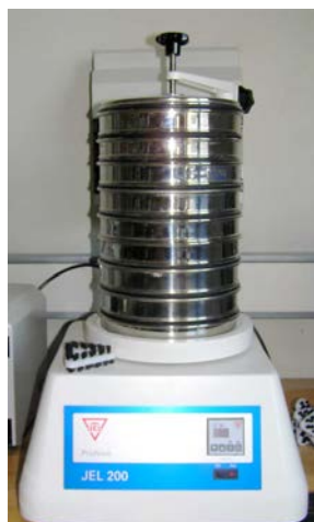
Figura 5.1: Setacci nell'agitatore meccanico.
