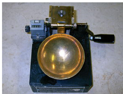
Figura 5.3: Cucchiaio di Casagrande.
