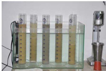
Figura 5.2: Vasca a temperatura controllata, cilindri graduati e frullatore necessari per la prova di sedimentazione.
